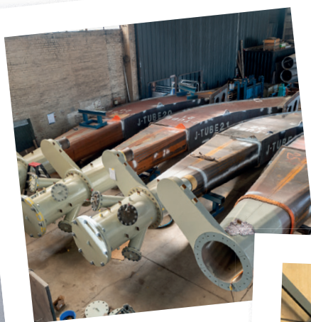
Vuylsteke produceert 88 J-Tubes, enorme stalen kabeldoorvoeren.
